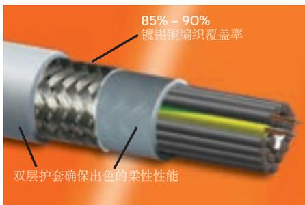
我们的高柔性屏蔽选项包括双层护套配置以及 85%覆盖率的编织屏蔽层，确保在达到设计要求的柔性性能时保持高屏蔽性能。对于扭转柔性的应用，我们提供覆盖率为90%的铜丝绕包屏蔽。
